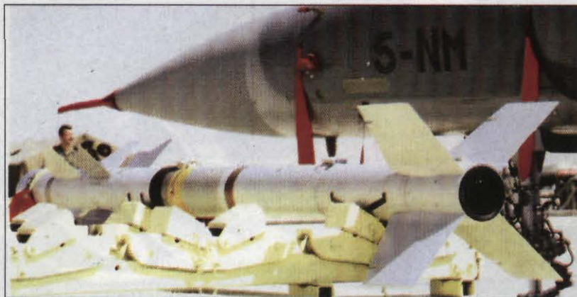
Rachetă cu cap de dirijare în infraroșu, de tip R 550 Magic II, de fabricație franceză.
