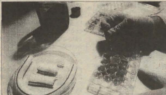
Pentru a evalua interacțiunile unui tub din plastic bioactiv cu țesuturile biologice, cercetătorii au introdus bucăți din acesta în culturi de celule. Scopul lor este de a găsi protezele vasculare în mod natural anticoagulante.
